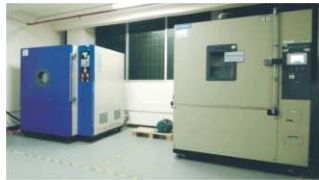
低气压测试箱（左）， 恒温恒湿测试箱（右）
