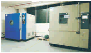
低气压测试箱（左）， 恒温恒湿测试箱（右）
