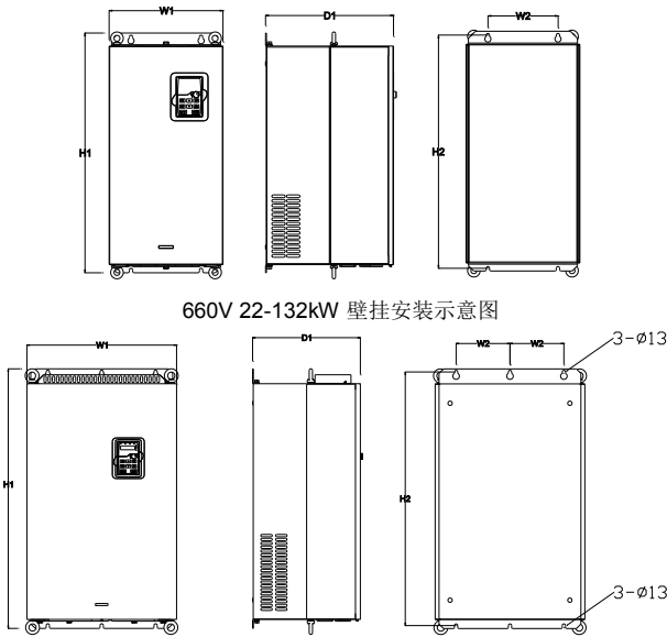
660V 160-220kW 壁挂安装示意图
